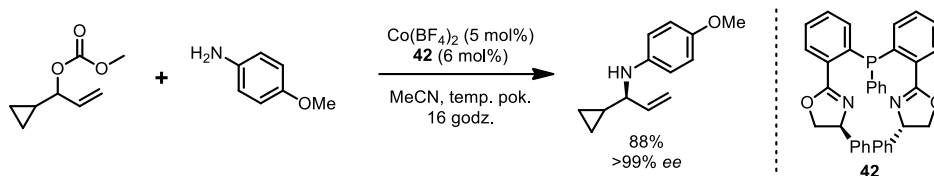
Schemat 31. Synteza rozgałęzionych alliloamin w reakcji Tsujiego-Trosta.
