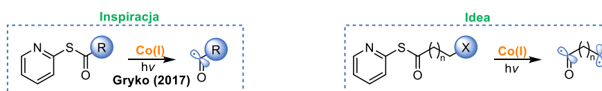
Schemat 3 Generowanie rodników alkilowych i acylowych z jednego reagenta
