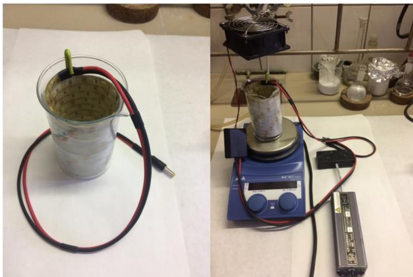
Rysunek 17 Zdjęcie 1: fotoreaktor w postaci zlewki wyłożonej taśmą LED; zdjęcie 2: zestaw do prowadzenia reakcji fotochemicznej składający się z fotoreaktora, wentylatora, mieszadła magnetycznego i zasilacza.
