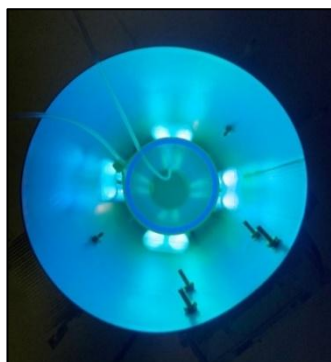
Rysunek 14. Pętla reakcyjna w fotoreaktorze podczas naświetlania.
